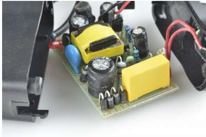
Možete li uočiti četiri diode koje čine prenosni ispravljač u ovoj zidnoj utičnici?
